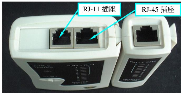
▶ 圖 5-7 RJ-45 測線器插座外觀
