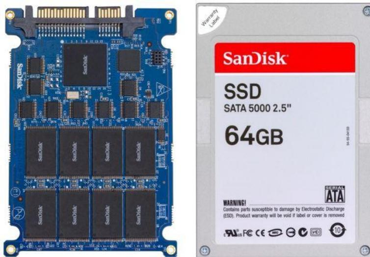
圖 4-10 SATA 固態硬碟(SSD)內部構造與外觀 (※ 圖片取材於網路)
