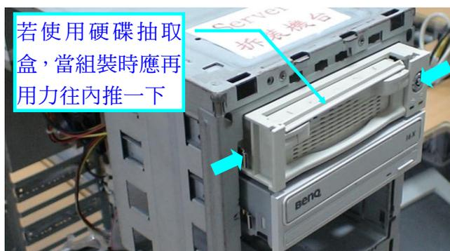
▶ 圖 4-3 抽取式硬碟盒與卡榫式機殼設計
