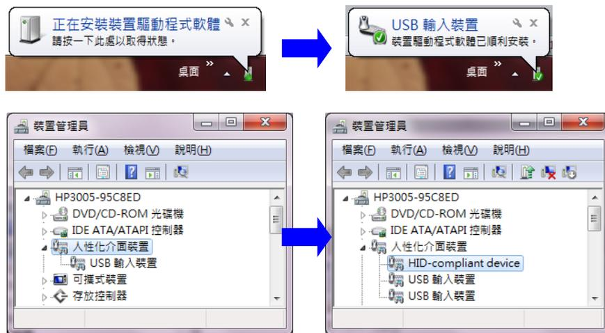
圖 2-10 如何判斷是否正確偵測到 USB 介面卡裝置
